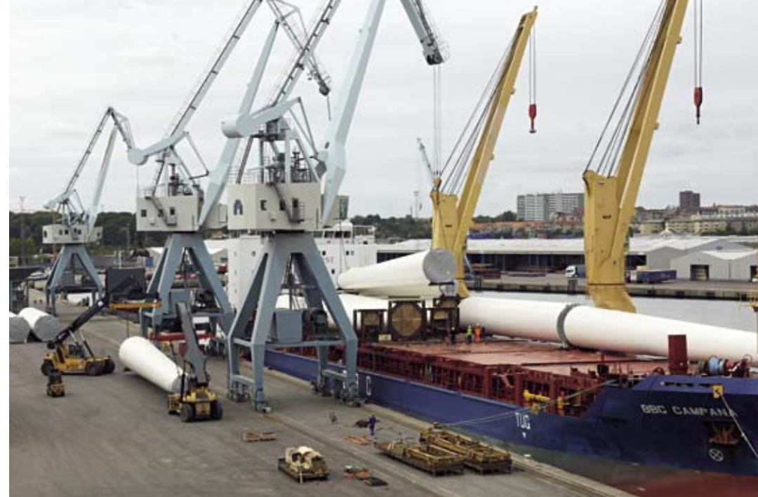
BBC Campana ved kaj 310 i Multiterminalen, hvor kran 7 og 8 klarer lastningen. Skibet er ligesom BBC Rosario 138 meter langt, 21 meter bredt og kan tage omkring 20 store vindmøller om bord.
