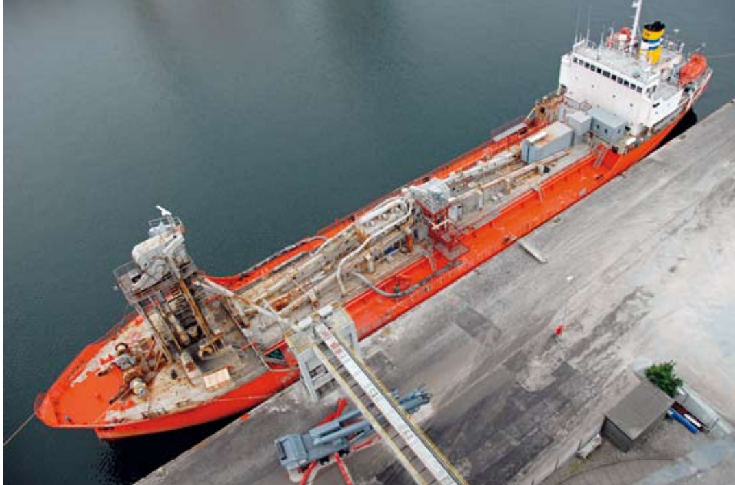
Fra skibene snegles cementen op i de 52 meter høje siloer på Oliehavnsvej.
