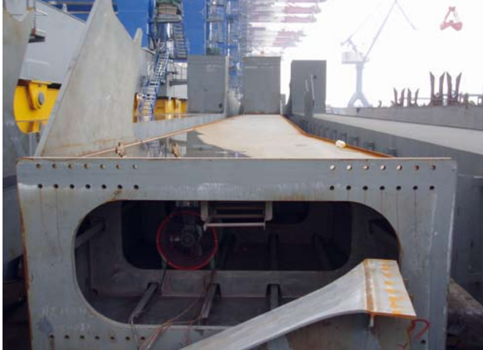
Kranbenene til Århus Havns nye Super Post Panamax kraner er næsten færdige. De ligger ude på ZPMC's kaj-område, hvor hele kranen senere skal samles.
