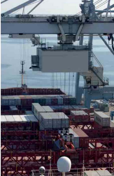
Kranerne på Århus havn er hurtige. En effektivitetsmåling har vist, at kranerne i gennemsnit foretager 34 løft pr. time. Det betyder, at en kran ca. hvert andet minut flytter en container til eller fra et skib.
