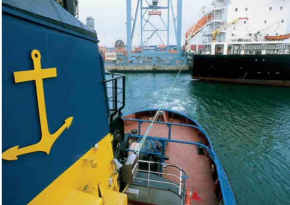
"Hermes" har en trækraft på 46 tons. Her er slæbebåden ved at assistere et skib i Containerterminal Nord. I 2004 udførte havnens to slæbebåde tilsammen mere end 900 bugseringer.
